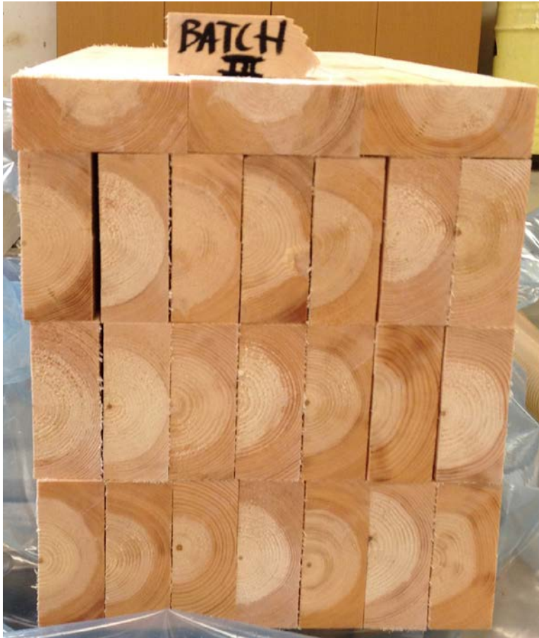
Figur 4 Råa tvärsnitt som visar mörkplacering och kärnvedsandel i en av batcherna före ändtätning.
