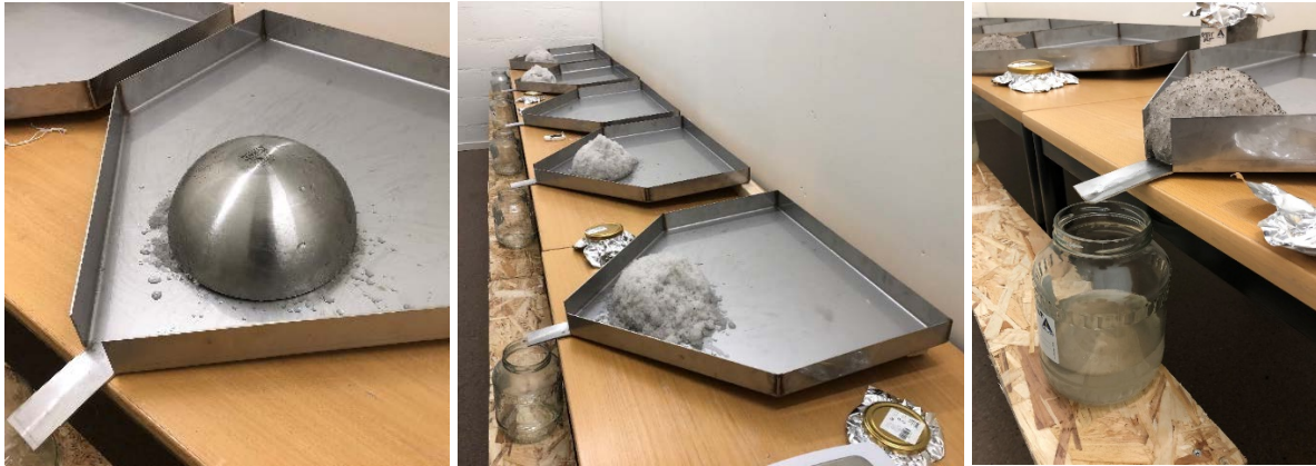
Figur 2. Försöksuppställning för bedömning av föroreningstransport vid snösmältning (foto av Peter Rosander)
