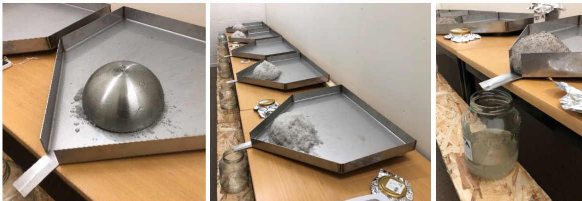
Figur 2. Försökupställning för bedömning av föroreningstransport vid snösmältning (foto av Peter Rosander)
