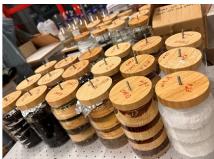
Försöksupställning av lakningsexperiment i laboratoriska skålar
