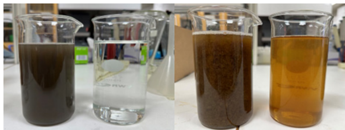
Vänster, dagvatten före och efter membranbehandling. Höger, rötat klosettwater före och efter membranbehandling.
